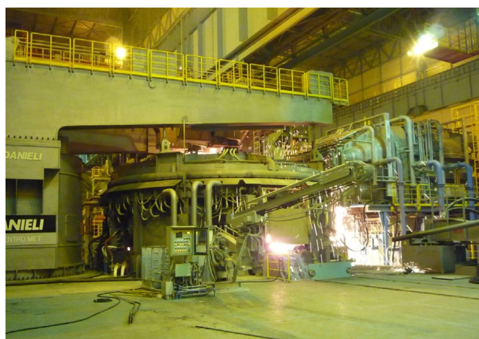
世界最大級の420トン電気炉 (田原工場)
