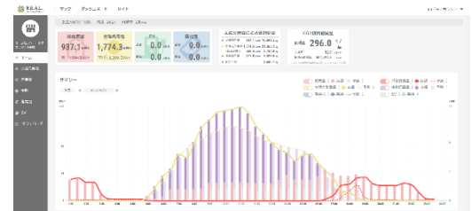
R.E.A.L. New Energy Platform®の管理画面 電力の需要と発電量の予測技術により余剰電力を算出
